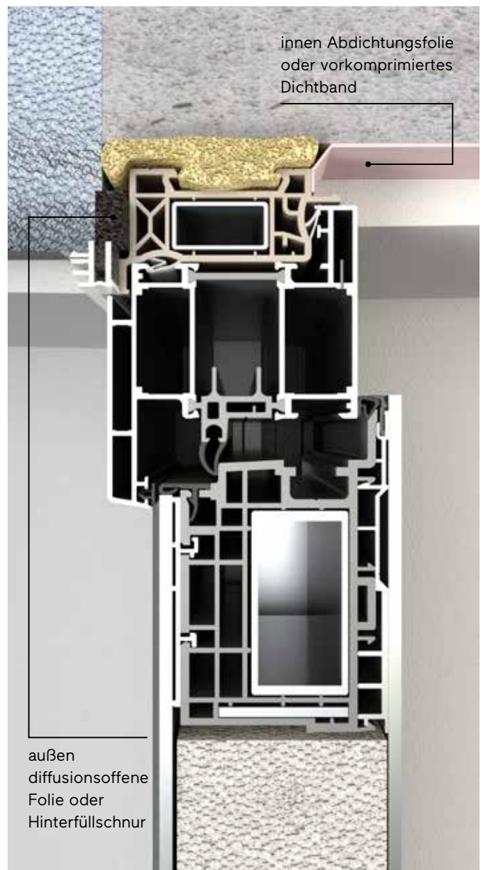
Zweistufige Montage mit Zarge
