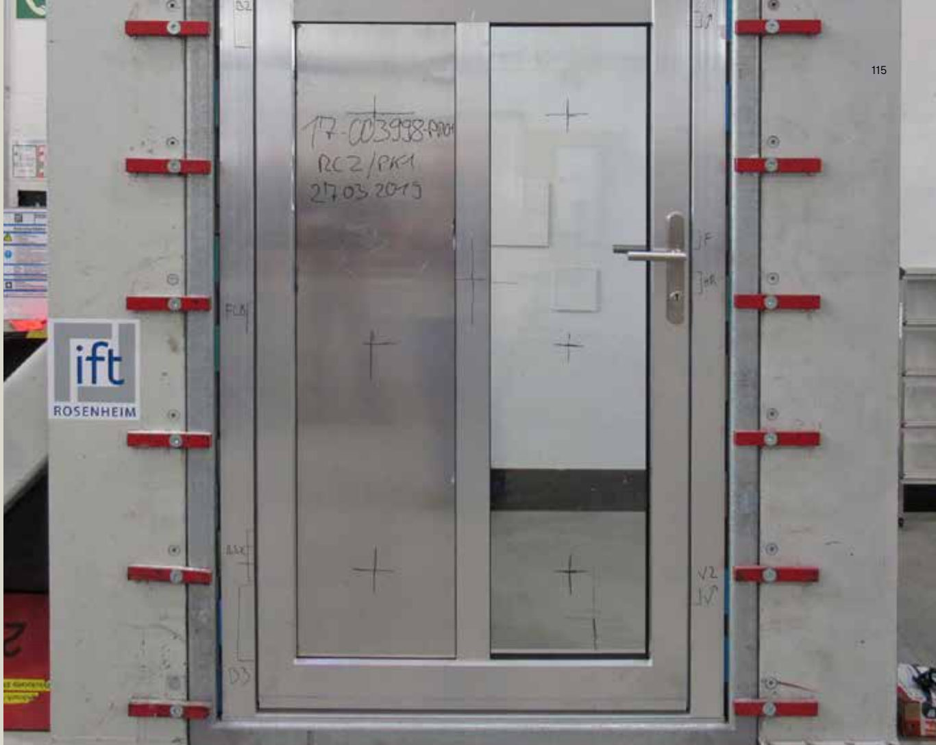
Am Prüfstand untersucht das Institut für Fenstertechnik (ift) Rosenheim die Einbruchsicherheit von Haustüren.
